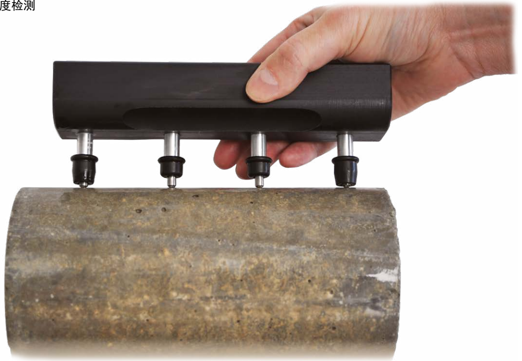
带有 1.5" (38mm) 探头间距的 Resipod 完全符合上述标准
