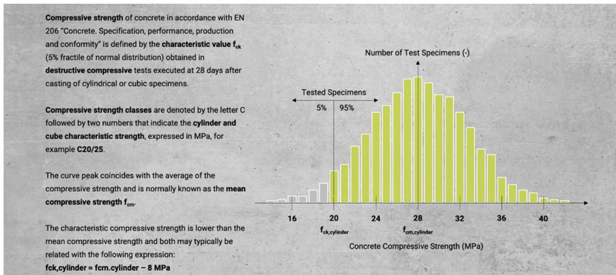
Es stimmt, dass die traditionellen Methoden der Betonfestigkeitsprüfung nicht ganz einfach und ziemlich kostspielig sind. Außerdem ist Beton nie gleichmäßig. Wenn Sie beim Gießen des Betons Proben entnehmen, werden diese Proben nicht so eingebaut, verdichtet oder ausgehärtet wie der Beton, der im realen Bauwerk eingebaut wird. Kernproben aus einem bestehenden Bauwerk werden bei der Entnahme gestört. All diese Faktoren wirken sich auf den geschätzten Festigkeitswert aus.
