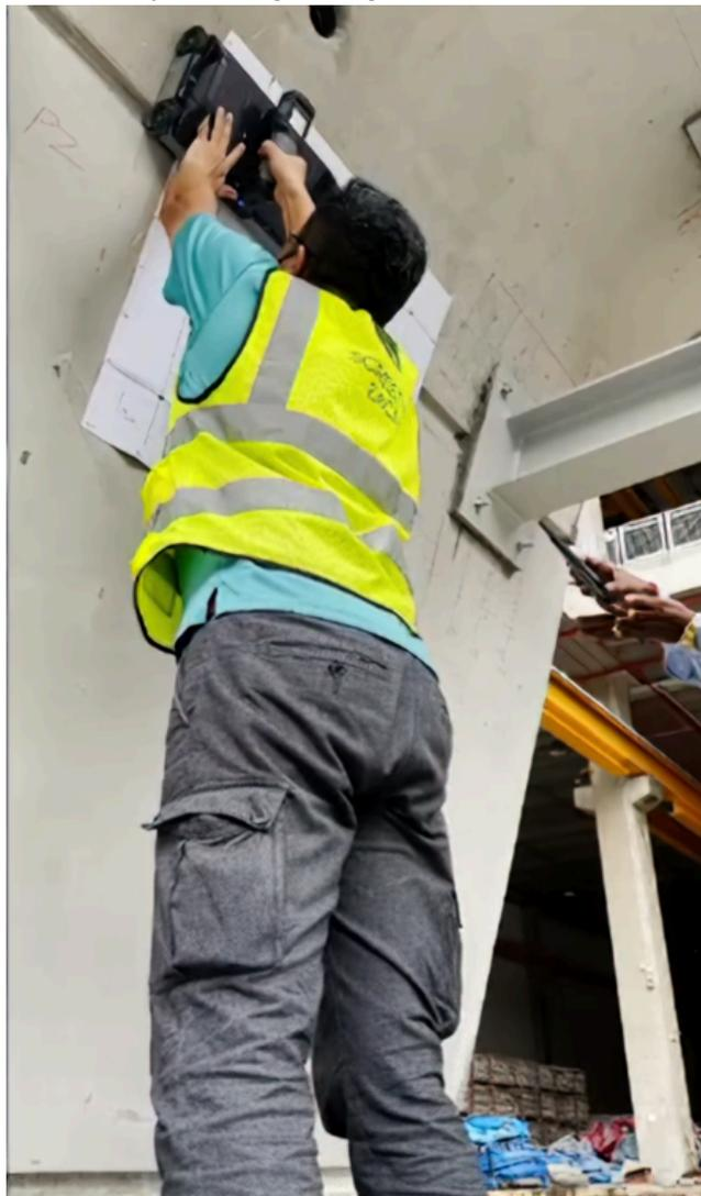
Mit Hilfe einer leistungsstarken Datenerfassungssoftware visualisiert das [GP8100](#) 3D-Daten in Echtzeit und die Ergebnisse können in verschiedenen Ansichten dargestellt werden, z. B. als Zeitschnitt oder als Augmented Reality (AR)-Ansicht des gescannten Bereichs. Die Einbettung der 2D- oder 3D-Ergebnisse auf der Baustelle mittels AR ermöglicht es uns, die Realität des Untergrunds so zu erfassen, wie sie ist, und einen intuitiven Bericht zu erstellen.
