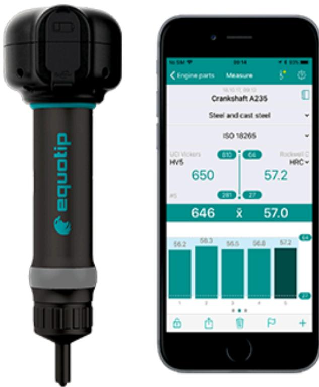
Pruebas de dureza
