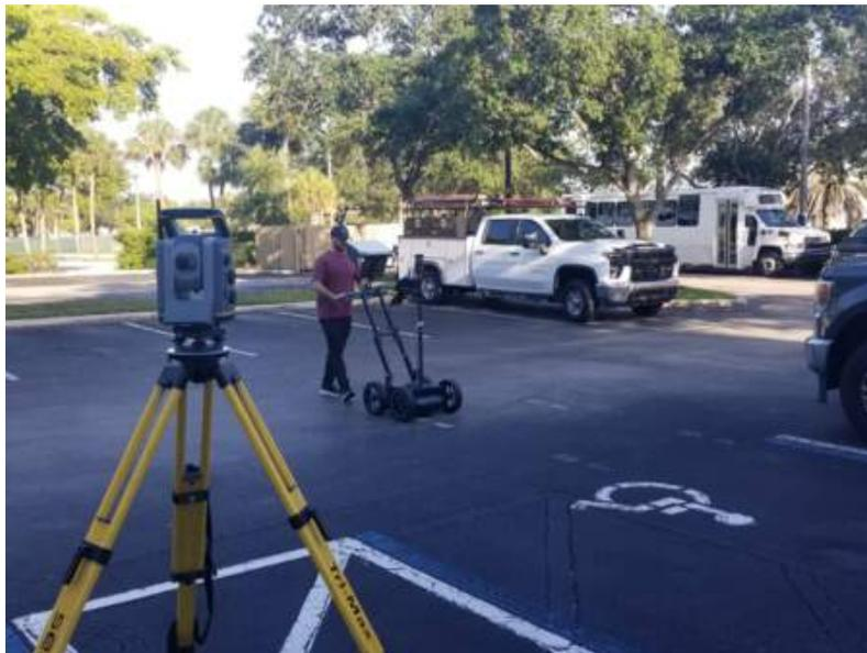
El Proceq GS8000 cuenta con una función única de "trayectoria libre" que permite al topógrafo caminar libremente, sin restricciones por una cuadrícula. El mapa térmico resultante del subsuelo se traza en un mapa en tiempo real, en el rango de profundidad deseado.
