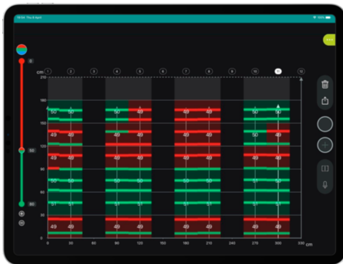
垂直线扫，精准锁定柱内箍筋
