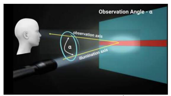
El ángulo entre el eje de iluminación y el eje de observación se mide como Ángulo de Observación - a.
