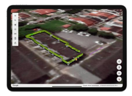
Se escaneó un área de 7 m por 3,5 m con una separación de 0,25 m y se localizó la tubería. El equipo pudo ver la tubería, su dirección y profundidad y visualizarla en realidad aumentada, lo que les permitió comprender su ubicación exacta.
