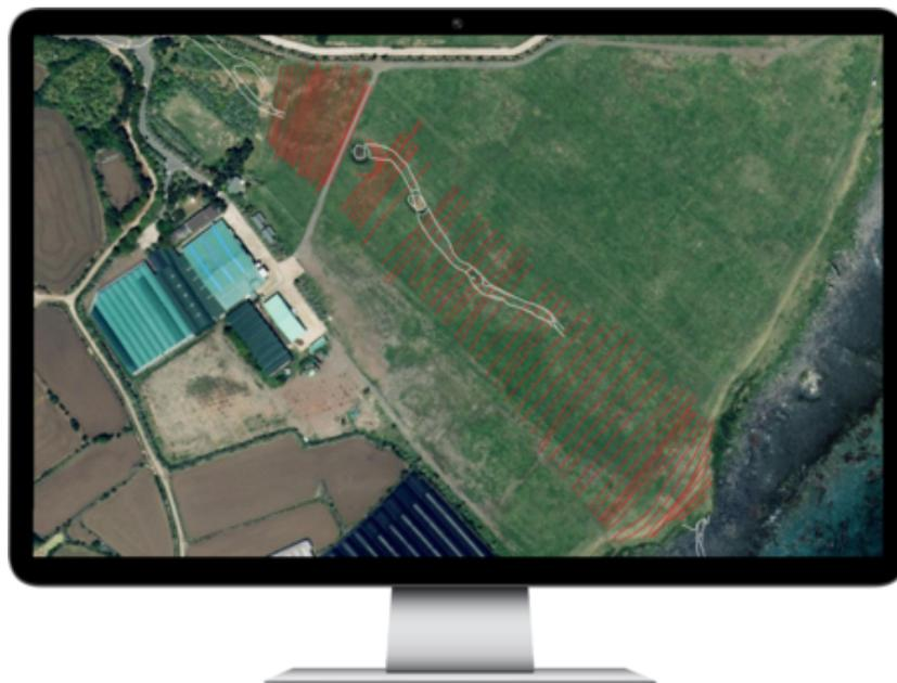
Para un análisis más profundo, el equipo utilizó el software de posprocesamiento [GPR Slice](#). En esta imagen, se pueden ver las líneas blancas que representan la distribución de la cueva de lava subterránea mediante escaneos 3D.
