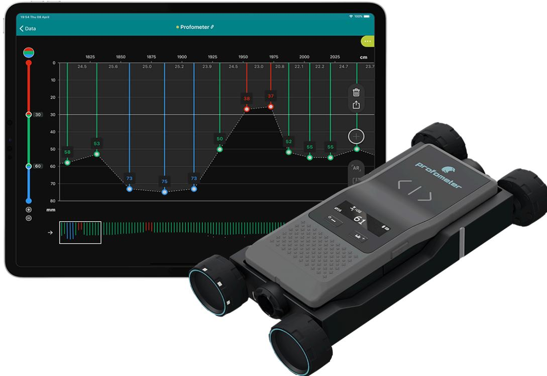
Profometer Mesureur de diamètre et d'enrobage des barres d'armature
