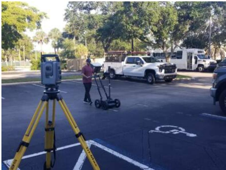
Le Proceq GS8000 est doté d'une fonction unique de "trajectoire libre" qui permet au géomètre de se déplacer librement, sans être contraint par une grille. La carte thermique du sous-sol qui en résulte est tracée sur une carte en temps réel, à la profondeur souhaitée.
