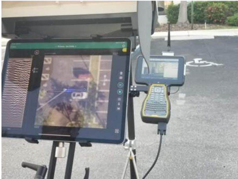
L'utilisation d'une station totale robotisée dotée de la fonction "free path" de Screening Eagle est très utile aux ingénieurs et aux géomètres spécialisés dans les services publics souterrains. Une carte du sous-sol est générée immédiatement sans qu'il soit nécessaire de procéder à de multiples étapes de traitement ou d'effectuer d'autres travaux hors site. Le flux de travail est rationalisé et peut être réalisé par une seule personne.
