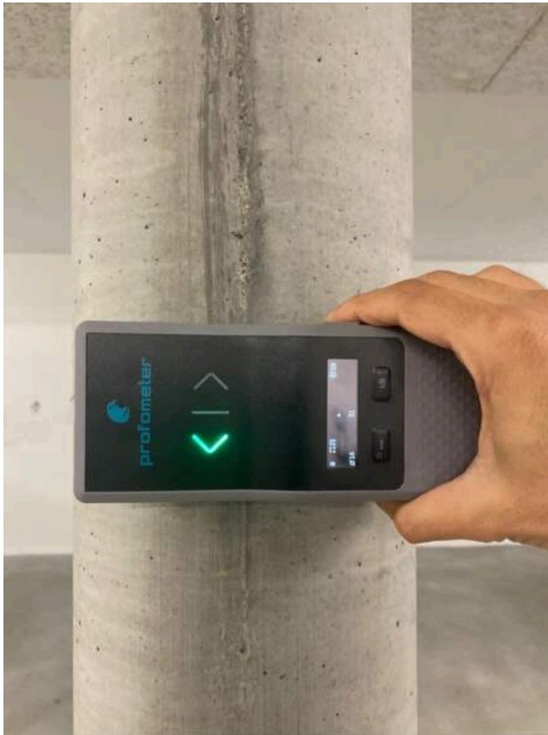
Utilisé comme appareil autonome sans iPad ni roues, le PM8000 Lite constitue la solution idéale pour cette application. La correction de l'armature voisine prend automatiquement en compte l'influence de l'armature de la deuxième couche, ce qui vous permet d'obtenir des résultats précis à chaque fois. Vous pouvez désormais maîtriser la complexité de l'inspection des colonnes et des poutres rondes à l'aide d'une solution fiable et facile à utiliser.
