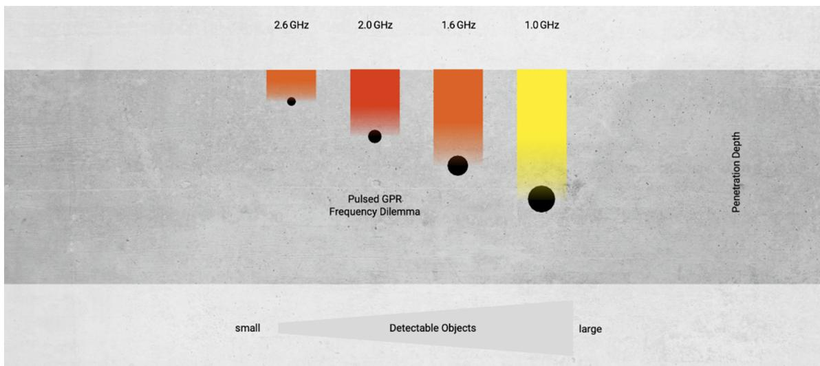
Cela est possible grâce aux scanners GPR pour béton les plus avancés au monde, la famille Proceq GPR.
