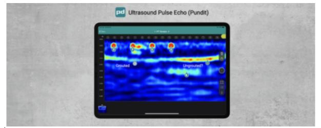
Évaluez l'homogénéité et la qualité du béton, détectez les défauts internes et estimez la profondeur d'éventuelles fissures à l'aide de la tomographie à ultrasons avec le Pundit Live Array.
