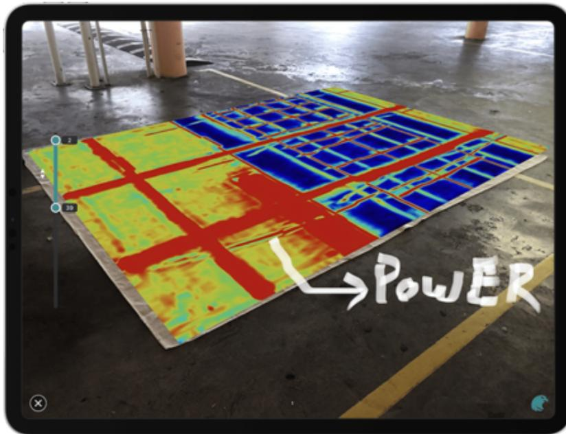
En résumé, le GP8100 permet de scanner très rapidement de grandes surfaces de béton avec des résultats immédiats faciles à interpréter. Cela augmente la productivité et la fiabilité de la société d'inspection et de toutes les parties prenantes du projet.
