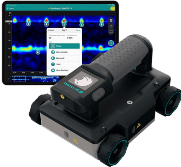
Radar a penetrazione del terreno Proceq
