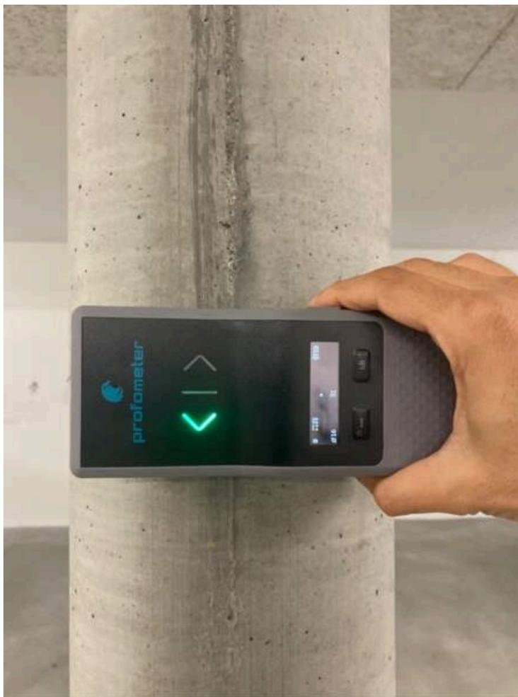
Utilizzato come dispositivo autonomo senza iPad o ruote, il PM8000 Lite è la soluzione ideale per questa applicazione. La correzione delle armature vicine tiene conto automaticamente dell'influenza delle armature del secondo strato, fornendo risultati sempre accurati. Ora è possibile superare la complessità dell'ispezione di colonne e travi tonde con una soluzione affidabile e facile da usare.
