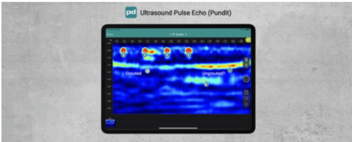
Avalie a homogeneidade e a qualidade do concreto, detecte defeitos internos e estime a profundidade de quaisquer fissuras usando tomografia ultrassônica com o Pundit Live Array.
