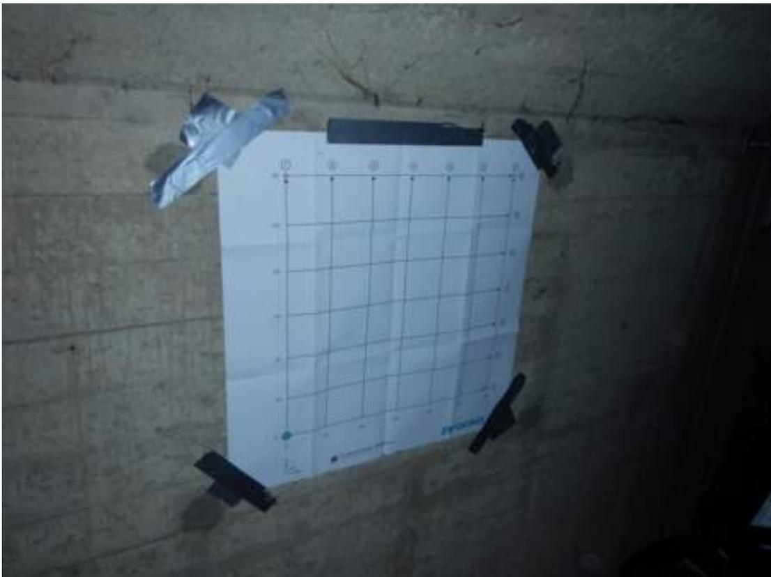
Onde a maioria dos equipamentos pararia, a nossa tecnologia SFCW proporcionou uma penetração em profundidade suficiente para o empreiteiro alcançar os vergalhões a 50 cm de profundidade. O GP8000 forneceu informações exactas sobre a profundidade e o espaçamento dos vergalhões que se encontravam na parede traseira e estes resultados foram verificados com núcleos de Ø200. Com base nesta informação, o empreiteiro forneceu informação suficiente aos engenheiros de estruturas para finalizar o projeto.
