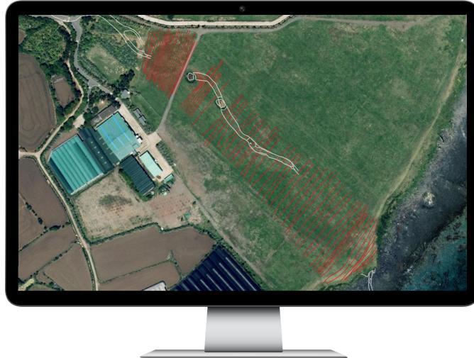
Для более глубокого анализа команда использовала программное обеспечение для постобработки [GPR Slice](#). На этом изображении видны белые линии, которые представляют собой распределение подземной лавовой пещеры с помощью 3D-сканирования.
