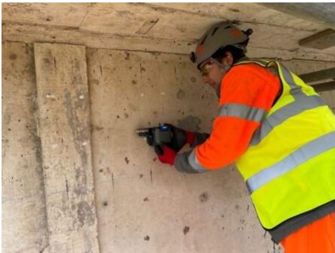
The Proceq GP8800 GPR being used to locate the post-tension ducts 接下来，使用 Pundit PD8050 超声波成像系统 检测后张拉管道上的空隙和缺陷。
