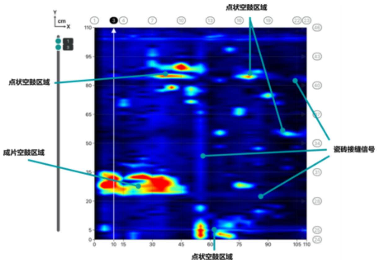
此外，可观察到空鼓区域多出现在瓷砖接缝位置。根据现场工程师反馈，这符合空鼓的一般形成位置—接缝处不密实而导致空鼓的逐渐生成和生长。
