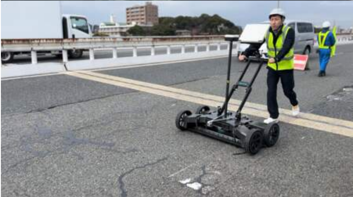
工作人员正推着GS9000探地雷达在桥面上进行探测
